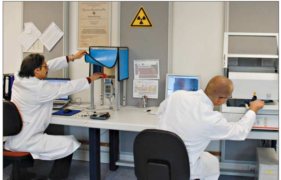
Bild 1: Die abgeschirmte Probenkammer mit Tischhalterung für das Niton-Handgerät (links) und das stationäre Vollschutzgerät Xdal von Fischer bei Hansecontrol in Hamburg
